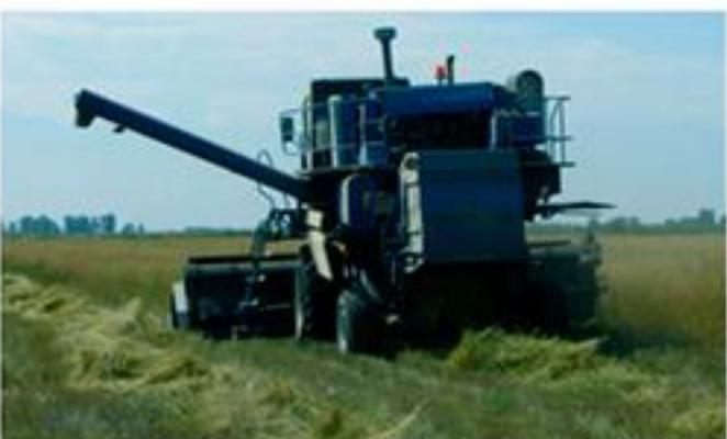
Зерноуборочный комбайн "Енисей-1200Н" с усовершенствованной наклонной камерой, прямое комбайнирование в Алматинской области
