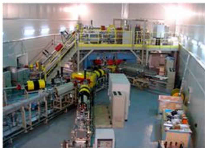
Ускоритель ВС 60 для облучения образцов высокозергетическими ионами
