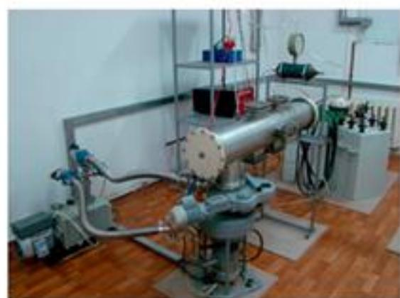
Стенд импульсного плазменного ускорителя коаксиального типа
