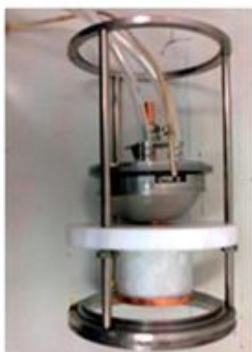
Система охлаждения катода распылительной системы
