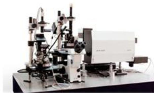
Спектроскопический комплекс "Интегра Спектра" на базе АСМ и зондово-усиленной спектроскопии КРС с предельным разрешением на уровне 10 нм
