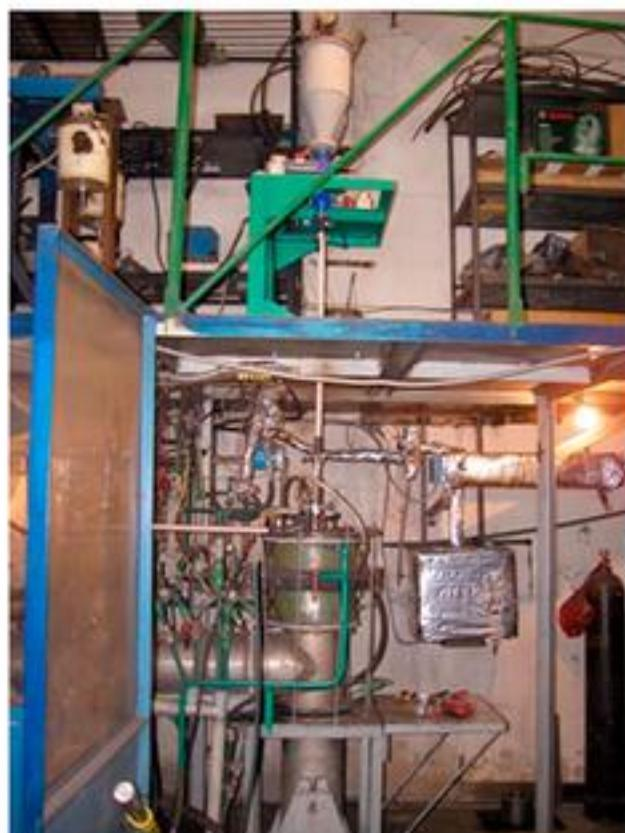
Модернизированная плазменная установка для гидрогенизации твердого топлива
