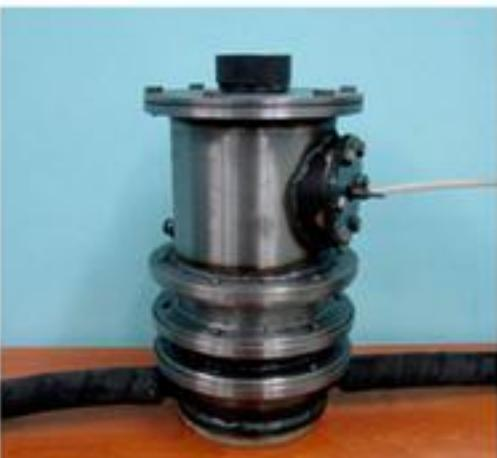
Рабочая камера электроимпульсного измельчителя установки ЭУИ-508
