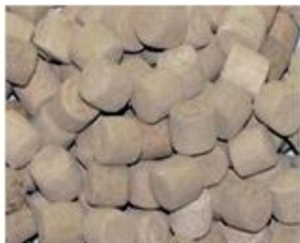
Катализатор 0,5 % Ru/γ-Al<sub>2</sub>O<sub>3</sub> цилиндрической формы после 36 ч работы
