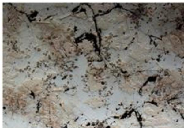
Микроструктура сплава КАМС
