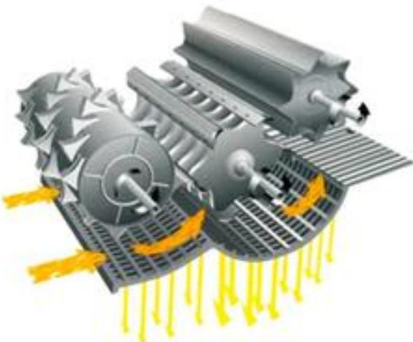
Молотильный барабан с ускорителем
