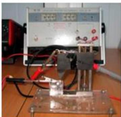
Установка для электролитической гидрогенизации графита
